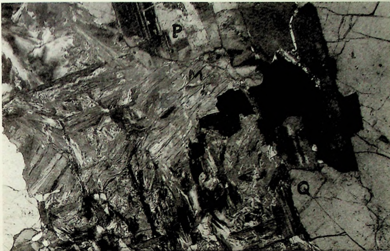
Foto nº 5: Muestra del alféizar de la ventana a la Plaza de Benavente. Monzogranito biotítico con cordierita (moscovita accesoria). Agregado de micas verde y blanca (M) de sustitución pseudomórfica de un gran cristal de cordierita. En un extremo de la foto, plagioclasa (P) y cuarzo (Q). NX (nícoles cruzados). 50x.
