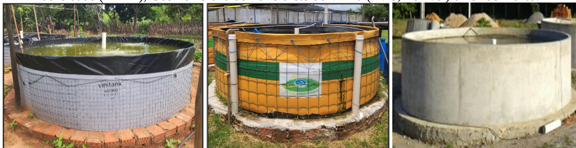
Figura 2. Tanques de recirculação, da esquerda para a direita: Geomembrana de Polietileno de Alta densidade (PEAD); Geomembrana de Policloreto de Vinila (PVC, flexível) e Ferrocimento.
