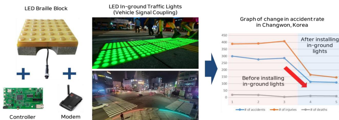
Figura 1. Semáforos LED empotrados en el suelo y el efecto de su instalación
