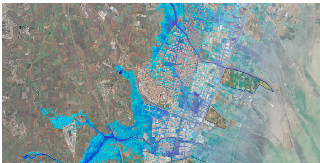
Figura 1. Ortofotografía aérea de la zona de Albal-Catarroja-Massanassa. Superposición zona inundable T-500 años y zonas inundadas en la DANA del 29/10/2024. Fuente: elaboración propia a partir de información extraída del visor del SNCZI y visor cartográfico de la Generalitat Valenciana.
