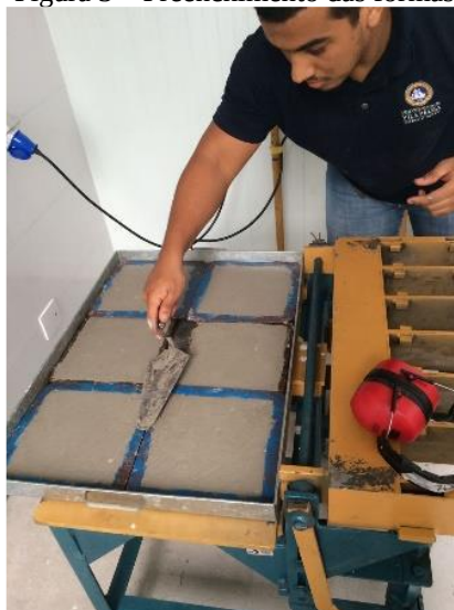
Figura 3 – Preenchimento das formas
