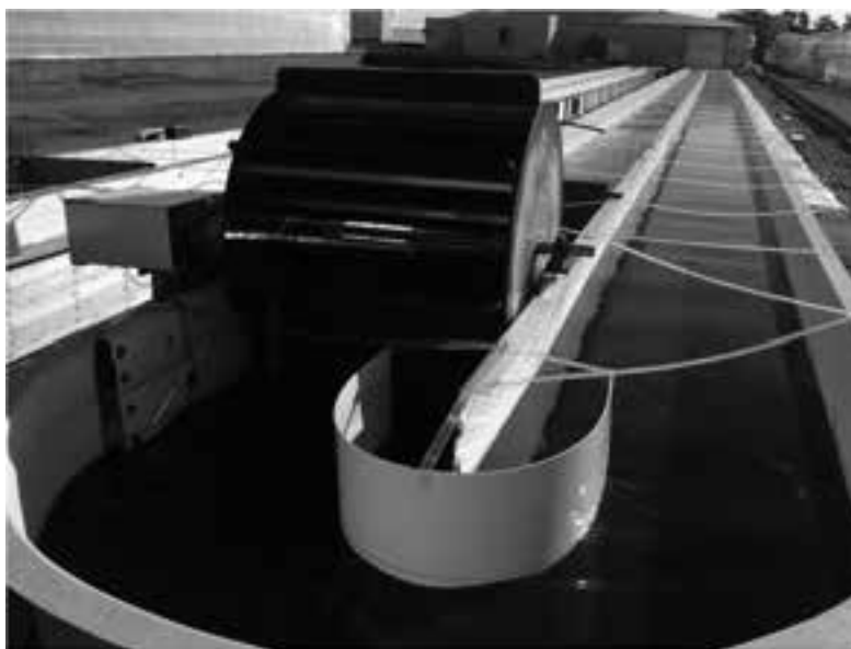
Figura 1. Imagen de reactor raceway de 20 m 3 como ejemplo de reactor abierto. Reactor instalado y operado en la Estación Experimental Cajamar
