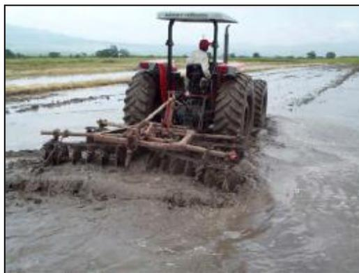
**Figura 3.** Proceso de fangueo con rastra pesada.
