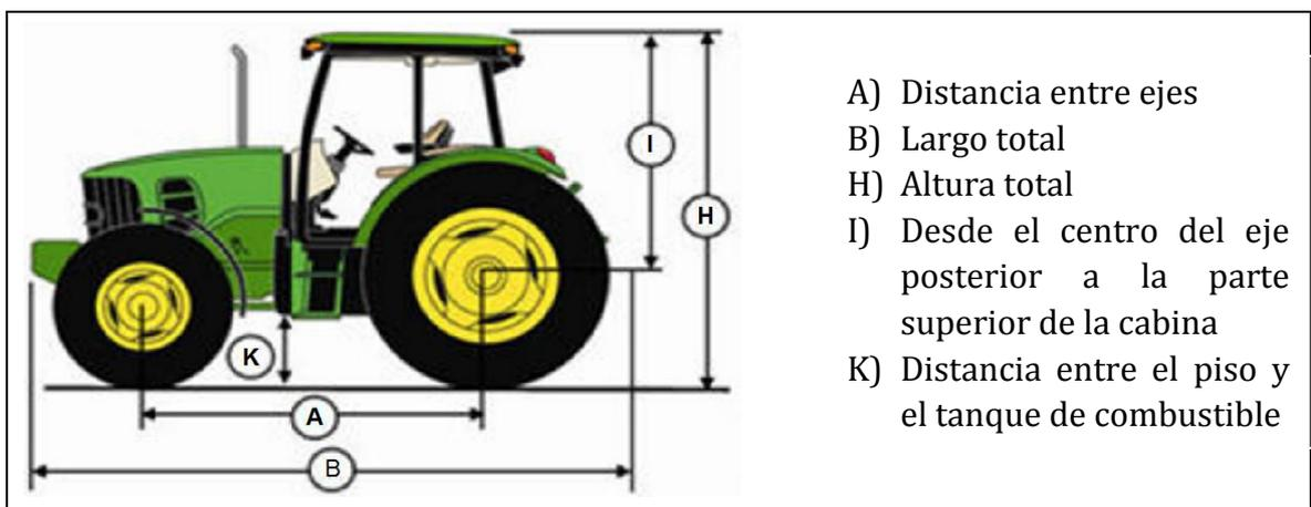
**Figura 5.** Dimensiones del tractor John Deere 6125D
