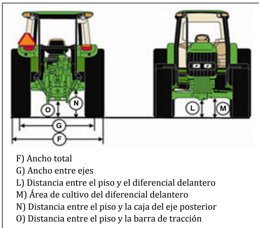
**Figura 6.** Dimensiones del tractor John Deere 6125D (continuación)
