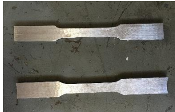
Figura 6. Probetas para ensayo de tracción bajo la Norma ASTM E8.
