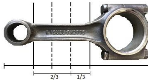
Figura 2. Masas alternativas y rotatorias en el brazo de biela.
