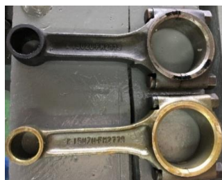
Figura 5. Biela usada y nueva del vehículo
