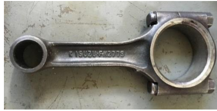
Figura 1. Brazo de biela motor Isuzu G200.
