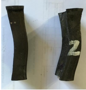
Figura 10. Muestras después del ensayo de compresión.
