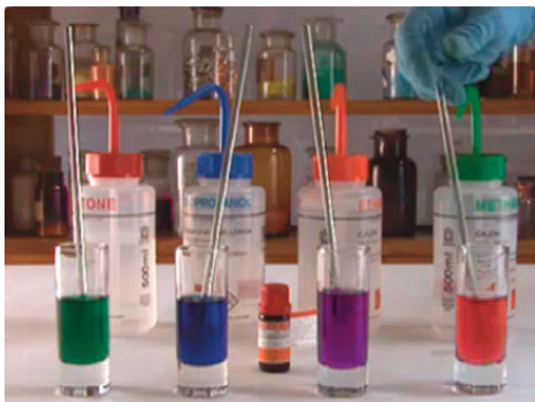
Figura 2. Solvatochromismo mostrado por una sustancia química en presencia de distintos tipos de disolventes. Imagen tomada de Chem-Toddler.com
